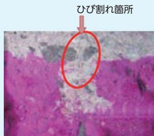
ひび割れ周囲のコンクリートの中性化
