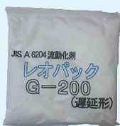
現場で良く使われる流動化剤「レオパック」 夏用(3~11月)、冬用(11月~3月)によって使い分ける
