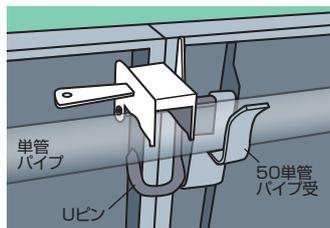
① 単管の上から、型枠のUピンに差し込みます。
